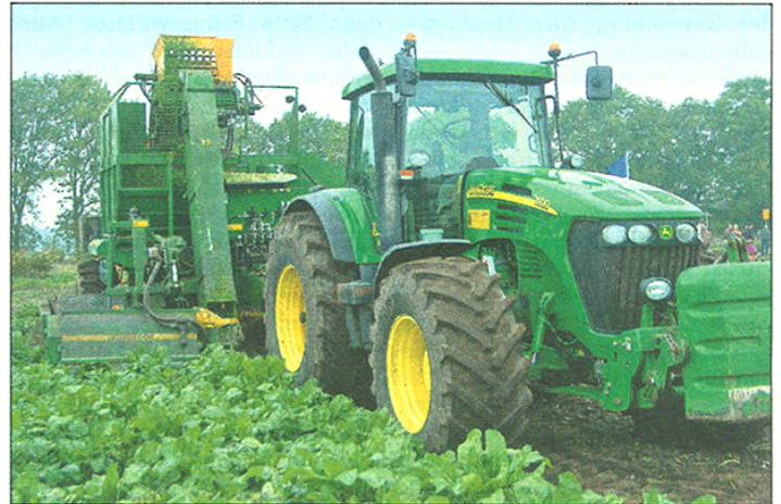
Dieser von Thyregod entwickelte Rübenroder reinigt und schnitzelt die Rüben so, dass sie ohne zusätzliche Wäsche und Nachzerkleinerung siliert werden können.
