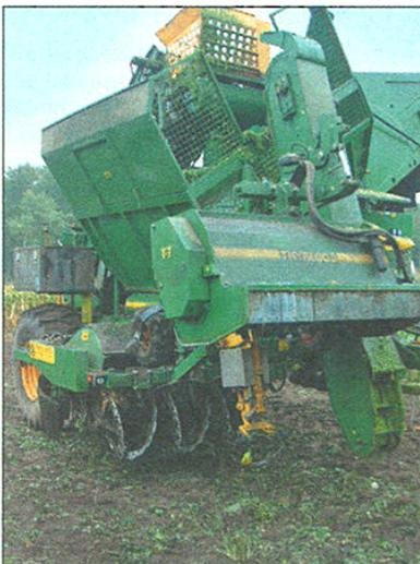
Von dem (hier im Bild hochgefahrenen) Schlegelköpfer wird das Rübenblatt über den rechts angebrachten Elevator in den Bunker gefördert. Unten zu sehen sind die V-förmig angeordneten Radrodeschare.
