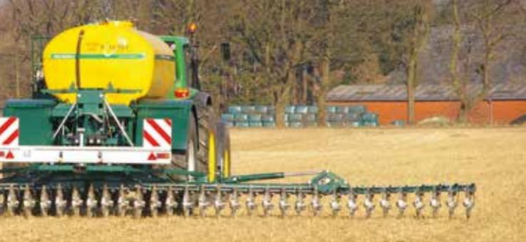
Injektionsdüngung mit Stachelrad: Der Dünger wird unterhalb der Mulchauflage abgelegt; dies beugt einer „Stickstoffsperre“ vor.
