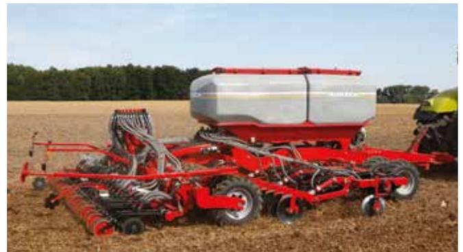
Strip Till Maschine Horsch Focus TD: Grundbodenbearbeitung, Saat und Düngung in einer Überfahrt.
